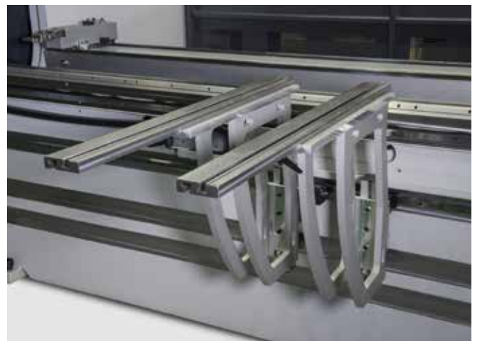
Auflagearme auf Führungsschienen ermöglichen eine schnelle Positionierung über die gesamte Biegelänge
