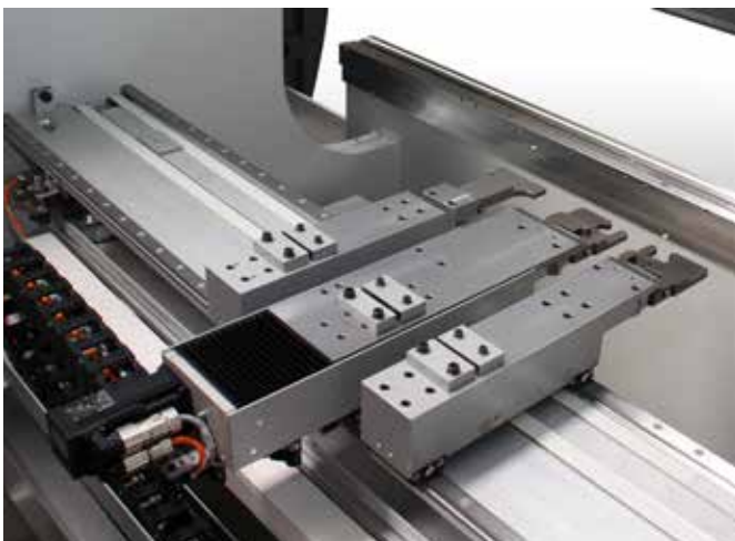
Zusätzlicher Finger zum Anschlagen langer, feiner Streifen
