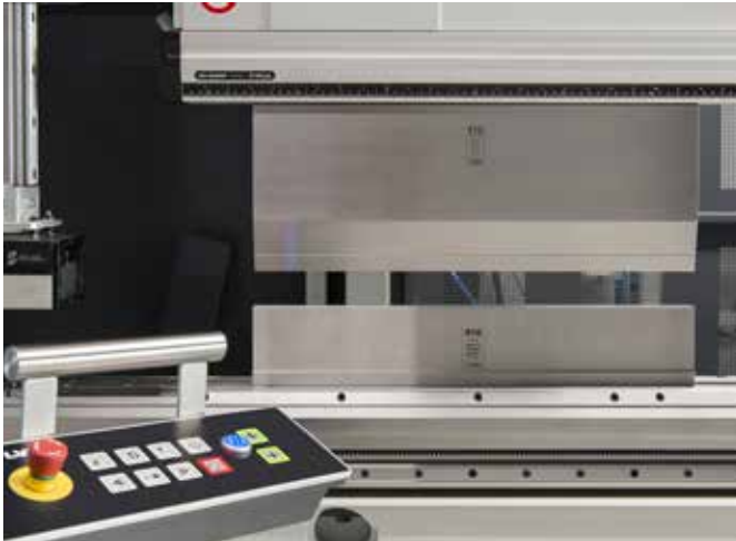
Schnell reagierende, hydraulische Klemmung am Stößel und am Tisch
