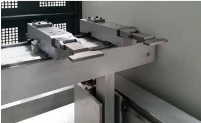
Standard Hinteranschlag mit zwei Achsen (X, R) und manueller Z-Achse bei PPEB-4 und PPEB-5
