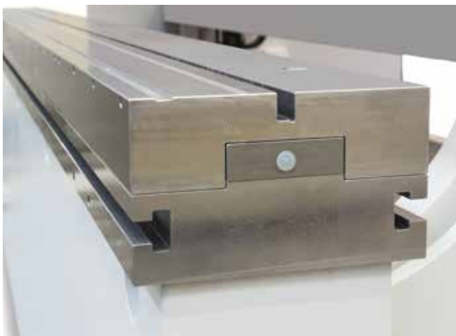
Breiterer Tisch für die Anwendung von Multi-V-Matrizen
