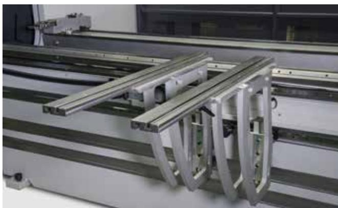
Les supports avant sur les rails de guidage permettent un positionnement rapide sur toute la longueur
