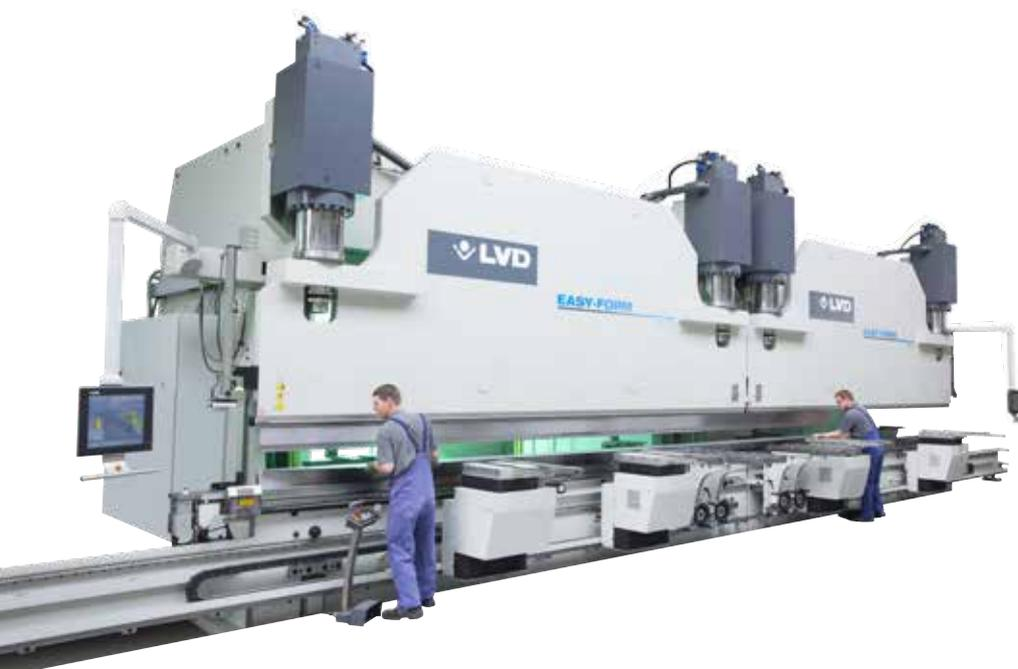
Fonctionnement en tandem : fonctionnement synchronisé de deux machines avec une seule commande numérique centrale ou fonctionnement indépendant de chaque machine avec des commandes séparées. Disponible avec des tonnages et longueurs différents en configuration tandem.
