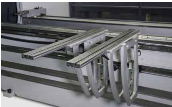
Il sistema frontale di supporto su guide permette il posizionamento veloce sull'intera lunghezza
